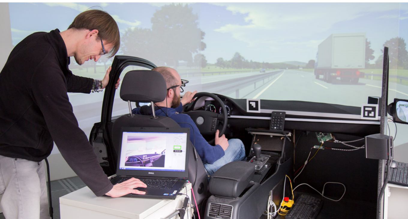
In einem Fahrsimulator erproben Wissenschaftler:innen von Universität und OFFIS Assistenzfunktionen für selbstfahrende Autos
